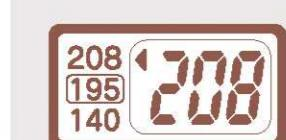
熱水溫度降到約208°F時，液晶顯示變換。
