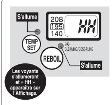
Faites attention de ne pas répéter le processus d'ébullition sans remplir d'eau le Récipient Interne comme le Revêtement Antiadhésif pourra se décolorer ou se décoller. La fonction de Fermeture Automatique s'active pour fermer le courant du réchaud afin d'empêcher des dégâts dûs à une surchauffe. L'Affichage montrera « HH » pour vous alerter que la fonction de Fermeture Automatique a été activée. Les conditions suivantes peuvent causer une activation.
