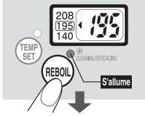
Quand le processus de réébullition est fini, le produit passe au mode Garder Chaud.
