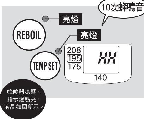
下列情況發生時，為了防止過熱而導致故障，將啟動防止空燒功能，並停止加熱器的供電，同時以亮燈告知。
