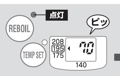
沸とうランプが点灯し、液晶表示部に水温を表示する
