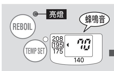
在沸騰燈亮時，液晶顯示面板將顯示水溫
