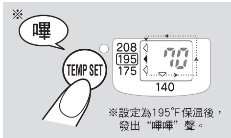
每按一次鍵，液晶顯示面板中的“◀”箭頭移動，請根據用途選擇設定。
