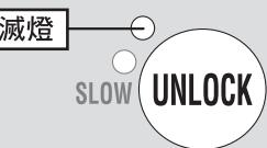
注水完畢約10秒鐘後，鎖定解除燈滅時，“給水”鍵會自動鎖定。
