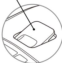
Nếu nút đóng mở nắp ngoài vẫn còn nhô lên, điều đó có nghĩa là nắp bình chưa được đóng hoàn toàn.
