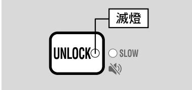
注水完畢約10秒鐘後，鎖定解除燈滅時，“給水”鍵會自動鎖定。
