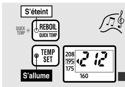
Quand la température de l'eau descend à environ 195 °F, « 195 » apparaît sur l'afficheur.
