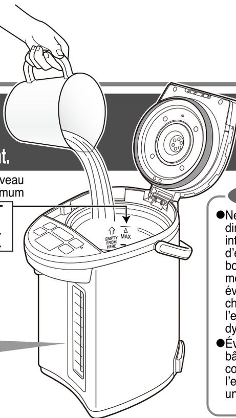
Pour vérifier la quantité d'eau versée dans la bouilloire, regarder l'épaisseur des bandes sur la jauge de niveau d'eau.
