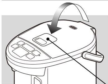
Bien fermer le couvercle supérieur. (Pour assurer un fonctionnement sûr pendant l'ébullition et pour éviter les ébouillantages si la bouilloire est renversée.)
