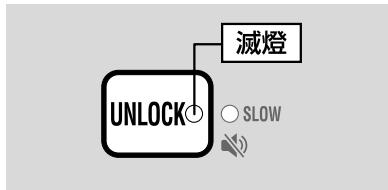
注水完畢約10秒鐘後，鎖定解除燈滅時，“給水”鍵會自動鎖定。
